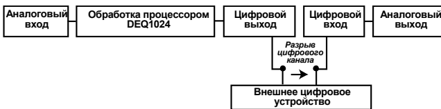
Рисунок 2.6: Прохождение сигнала в режиме POST EQ
