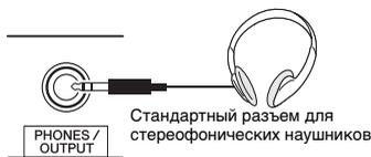
Подключите наушники в гнездо [PHONES/ OUTPUT]. Этот разъем может также служить внешним выходом. Подключив компьютер, усилитель клавиатуры, магнитофон или другое аудиоустройство, вы сможете воспроизводить сигнал этого инструмента на подключенном устройстве. При подключении штекера в это гнездо динамики инструмента автоматически отключаются.
