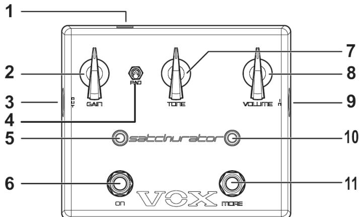
*Замечание: Перед подключением гитарного кабеля или адаптера питания, а также при смене батареи педали Satchurator обязательно отключайте гитарный усилитель от сети. В противном случае усилитель может выйти из строя.*
