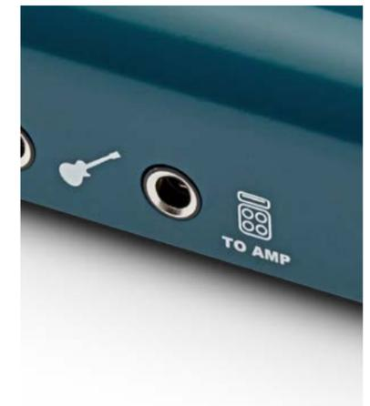
Чтобы подать звук на выход To Amp, просто направьте звук из вашей DAW на выход Output 3 (To Amp), и вставьте джек в гнездо To Amp.
